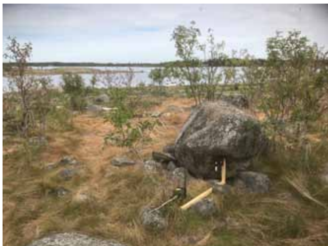
Figur 6a. Fällan monterad vertikalt på ställning, cirka 35 cm över markytan.
