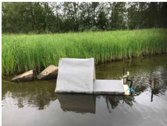
Figur 6 b. Fälla monterad på flotte. Taket krävdes för att minska antalet bilder från kameran.
